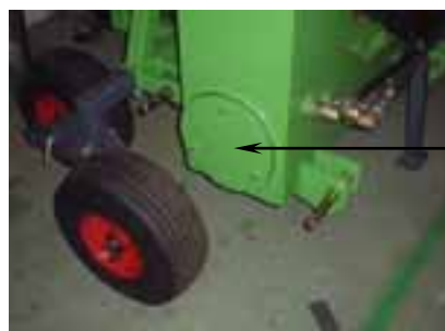
Trappe d'accès aux crépines
